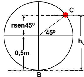
$$h_C = 0,5 + 0,5\text{sen}45^\circ = 0,853m \quad \text{(1pto)}$$
